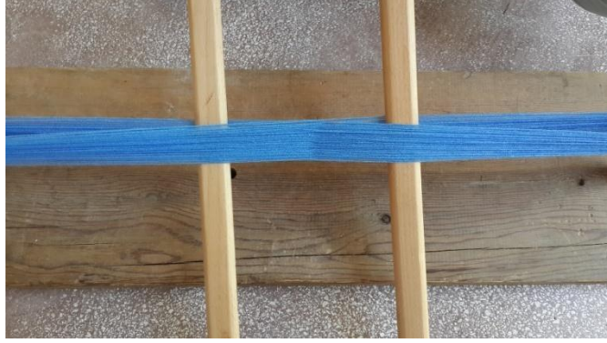
Resim 2.1: Çözü ipliği çapraz çubukları
