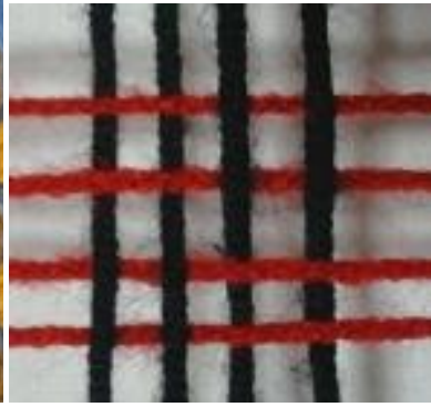
Resim 3.6: P 2/2 Düzenli panama örgüsü Resim 3.7: Açık görünümü
