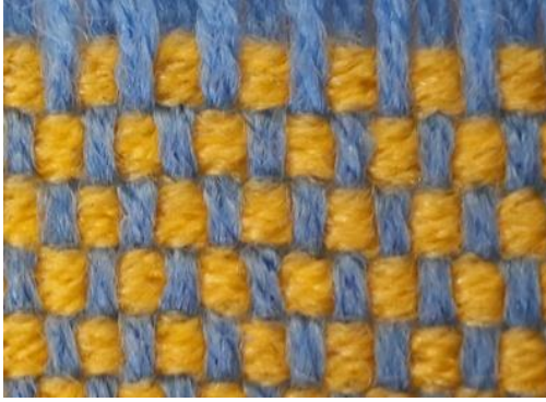
Resim 3.6: P 2/2 Düzenli panama örgüsü Resim 3.7: Açık görünümü
