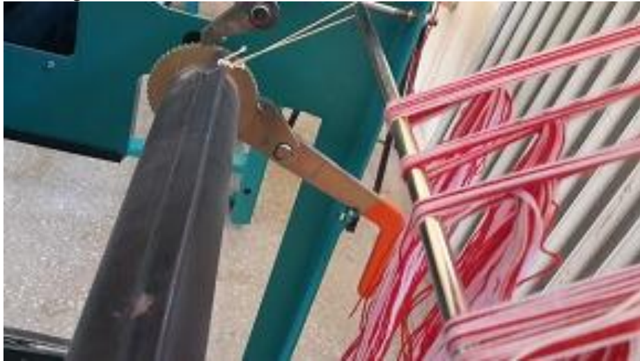
Resim 4.4: Kumaş levendi uç bezi bağlantısı
