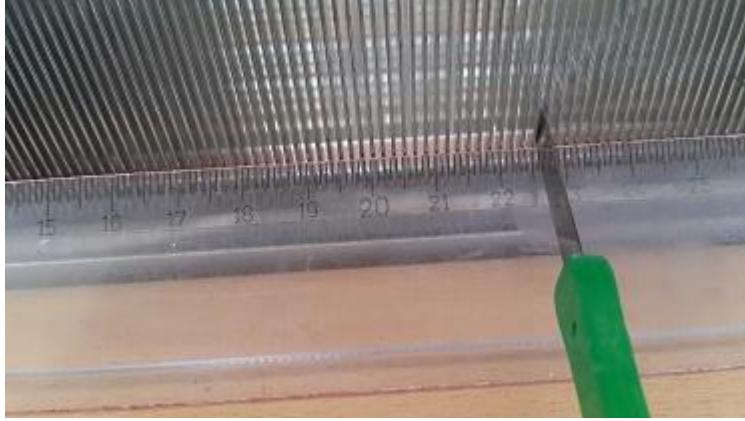
Resim 3.4: Tarak tahariçin ilk noktayı belirleme
